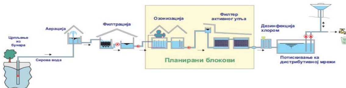
Слика 3.1.3.1. Схема технолошког процеса пречишћавања сирове воде до квалитета воде за пиће - ППВ "Шtrand"
