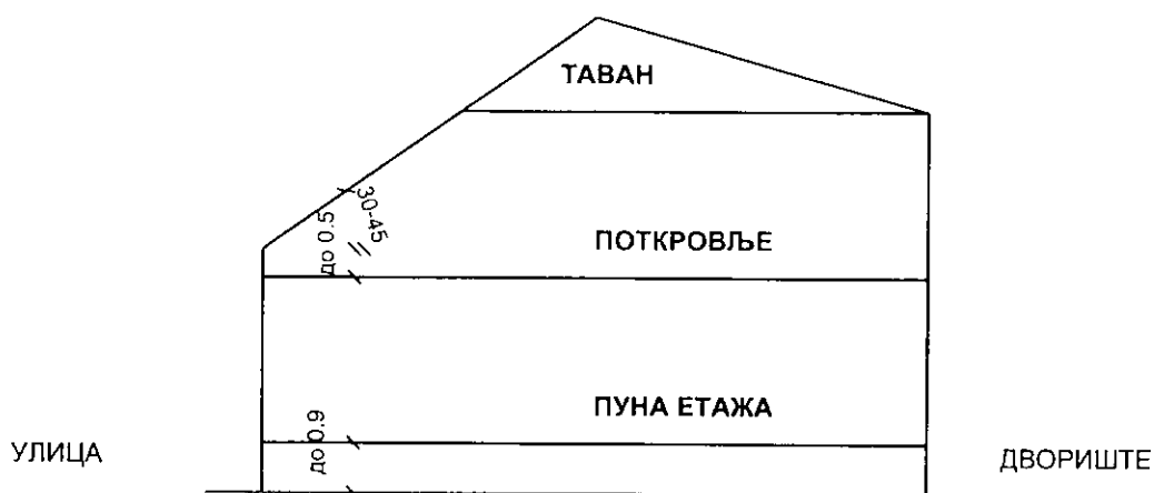
Скица број 1: Могући начин обликовања поткровља – попречни пресек
